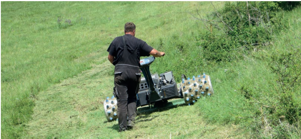
Bild 2: Demonstration eines Mulchmähers für Steillagen Bild: M. Ebert
