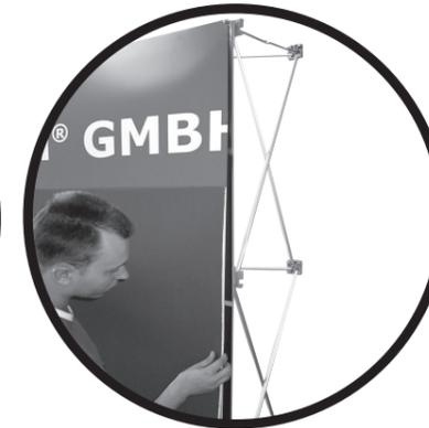
...und lassen die Bahnen an den Magnetschienen haften.
