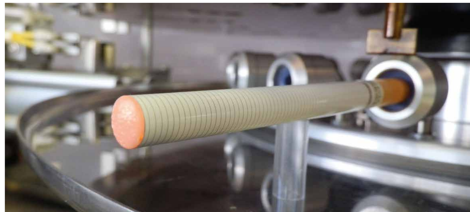
E-Zigarette in einer speziellen Abrauchmaschine für die Prüfung auf Schadstoffe
