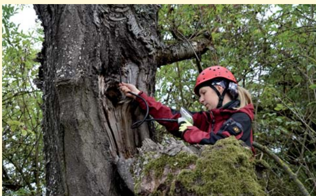
Untersuchung von Baumhöhlen als potenzielle Fortpflanzungs- und Ruhestätten für Fledermäuse und Vögel mit einer Endoskopkamera
