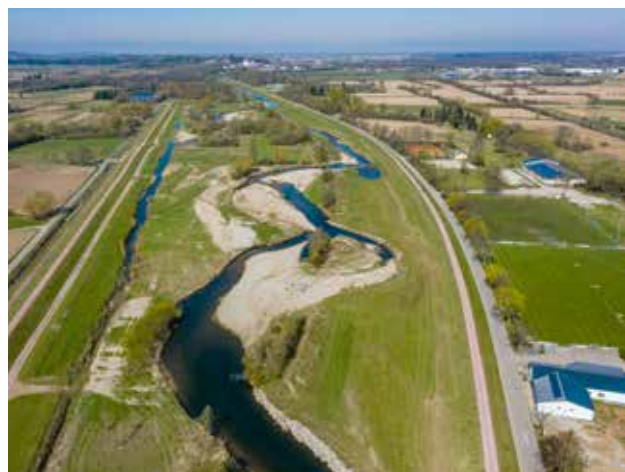
Abb. 5.3: Durch Renaturierungs- und Revitalisierungsprogramme wie hier an der Elz können vom Menschen stark veränderte Gewässer (links) wieder in einen natürlicheren Zustand zurückgeführt werden (rechts). Dies hat in der Regel auch einen positiven Effekt auf die Fischdiversität. Für die Planung solcher Maßnahmen müssen jedoch eine Reihe von Faktoren berücksichtigt werden (siehe Fließtext).
