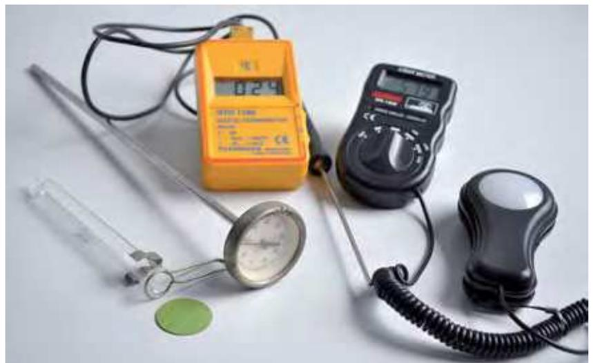
Abbildung 20: Geräte zur Erkundung an der Kräuterspirale von links: Evaporimeter nach Piché, Thermometer analog und digital, Luxmeter
