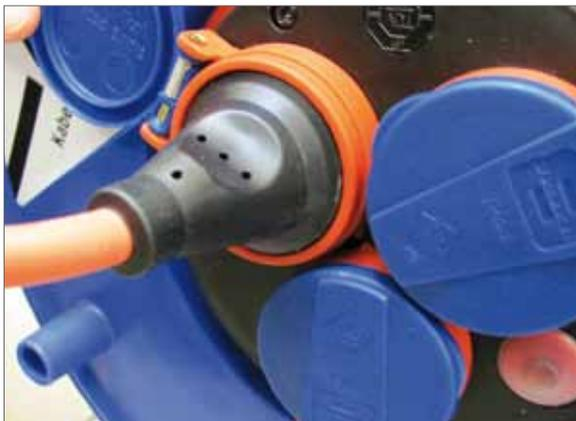
Knackpunkt bei LED-Spots ist die elektrische Spannungsfestigkeit. Spritzwassergeschützte Kabeltrommel
