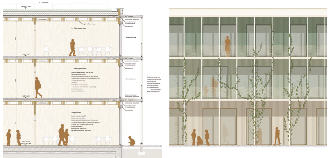
Abb. 11.4.2.1: Detail: Fassadenschnitt und Ansicht
