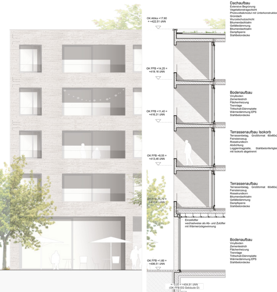
Detail: Fassadenschnitt und Ansicht
